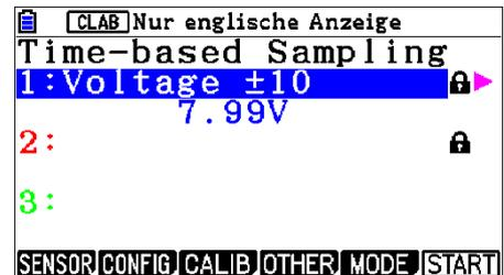
Die Messung soll bei Unterschreitung eines Schwellenwertes (hier 6V) starten. Dieser Wert muss unter dem Wert der Spannungsquelle liegen (hier 7,99V).
