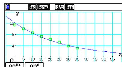
Alle Modelle sind einigermaßen akzeptabel. Allerdings sieht man beim linearen Modell deutlich eine Linkskrümmung im Punkteverlauf. Das quadratische Modell passt sich da etwas besser an als das exponentielle. Zur Überprüfung tragen Sie nun die übrigen Messwerte in die Listen 3 und 4 und erstellen Sie einen Scatterplot auf GPH2.
