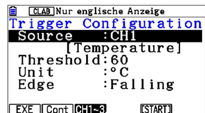
Die aktuelle Wassertemperatur beträgt 67,6°C. Da die Messung über einen Trigger gestartet werden soll, muss die Triggerschwelle einige Grad unter dieser Temperatur liegen. Hier sind es 60°C (vgl. Abschnitt 2.4).
